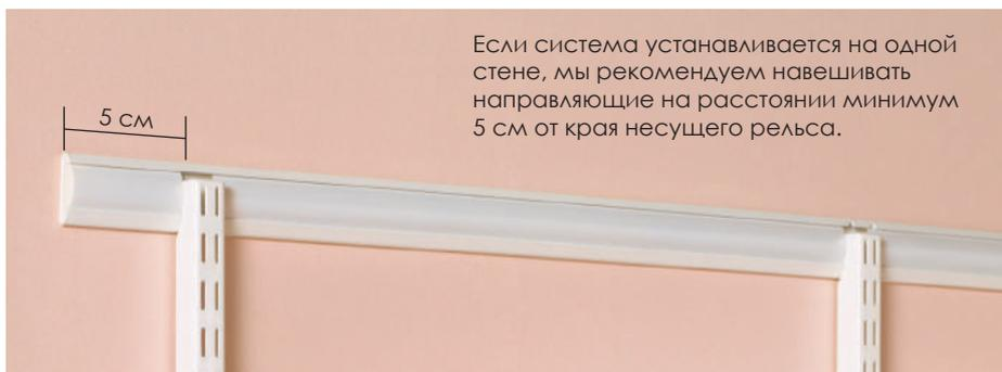
Если система устанавливается на одной стене, мы рекомендуем навешивать направляющие на расстоянии минимум 5 см от края несущего рельса.
